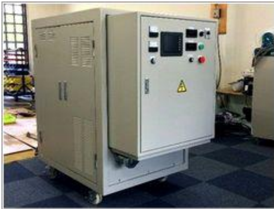
环保能源气体系统 KJC-2014-70h [燃料供给量 最大 150 L/h 规格]
